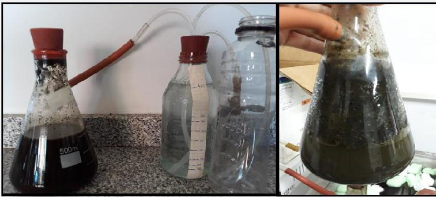
Figura 2: Reactor y sistema de desplazamiento para la medición de biogás a la izquierda, a la derecha reactor con *Ulva* sp.
